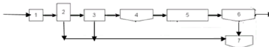
1- резервуар; 2-сепаратор твердых и жидких отходов; 3- резервуар первичной седиментации; 4 анаэробный резервуар; 5- резервуар аэрации; 6- резервуар вторичной седиментации; 7- шламонакопитель
